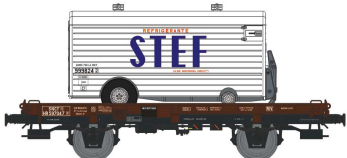
Réf. WB-071 - Wagon UFR Mono-Porteur Ep.III W-009-E-03 Wagon freiné, boîtes d'essieux coussinets, roues pleines N° 597047
