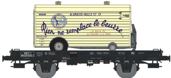
Réf. WB-072 - Wagon UFR Mono-Porteur Ep.III W-009-E-04 Wagon freiné, boîtes d'essieux coussinets, roues pleines N° 597009
