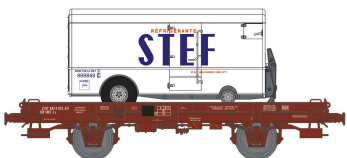
Réf. WB-074 - Wagon UFR Mono-Porteur Ep.IV W-009-E-06 Wagon freiné, boîtes d'essieux coussinets, roues pleines N° 21 87 042 0 032-6
