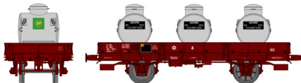
Réf. WB-131 – Wagon PLAT OCEM 29 Ep.IV W-008- E-05 Wagon freiné, boîtes d'essieux à coussinets, 1 roue à rayons, 1 roue pleine n°21 87 346 1 234-2 3 Containers Citernes BP
