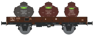
Réf. WB-061 - Wagon PLAT OCEM 29 Ep.III W-008-D-02 Wagon freiné, boîtes d'essieux à coussinets, roues pleines N°Jho 104006
