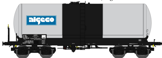
Réf. WB-182 - Wagon Citerne ANF Ep.V "ALGECO" W-018-J-02 – Citerne courte, bogie Y 25S boîtes SKF, N° 33 87 783 6 292-5
