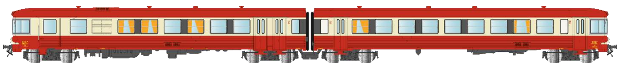
NW 169 : EAD version d'origine, toit rouge, trumeaux de fenêtres latérales gris, pare-brise avec vitres d'angle. XBD 4502 + remorque XRAB 8545, Marseille-Blancarde, Ep. III.
