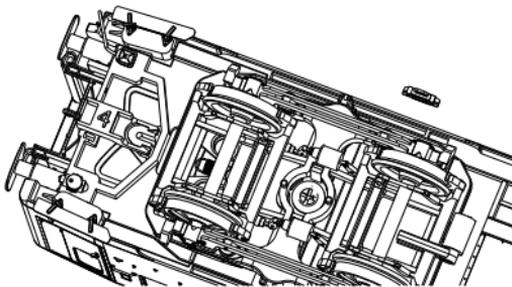
Monter les anneaux ferry dans les logements prévus à cet effet de part et d'autre du bogie. Une petite goutte de colle blanche évitera de les perdre et à l'avantage de pouvoir les enlever plus facilement si besoin.
