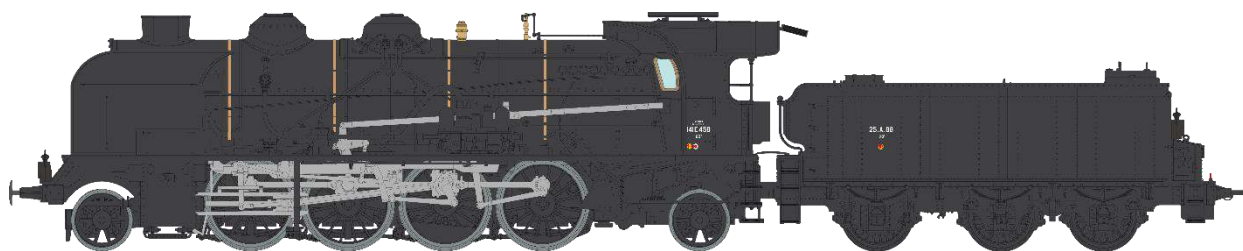
Machine 6-141 E 458 SNCF VEYNES cheminée double, grands écrans pare-fumée, pompe DABEG, tender 25 m 3 25 A 88
