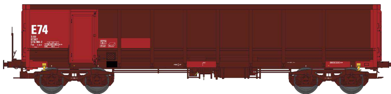
Réf. WBSE-018 - Wagon TOMBEREAU FAS Reconstitué Ep.V Bogie Y25 (REE) N°31 87 6 984-2 avec passerelle bicolore brun E84 + panneaux R606 (2004)
