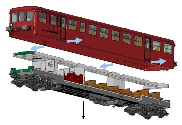
Afin de faciliter le démontage, il n'y a pas de liaison électrique entre caisse et châssis.
