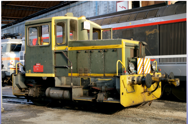
Photo : au dépôt de Chambéry, un Y-2200 devenu LOCOMA 0034 Equipé de l'attelage automatique BSI - B. Delahaye
